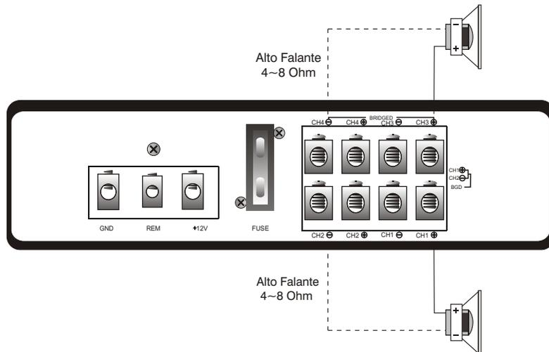
Repare que os quatro alto-falantes foram ligados na mesma polaridade dos terminais do amplificador (+) e (-) conforme mostra a figura acima .
